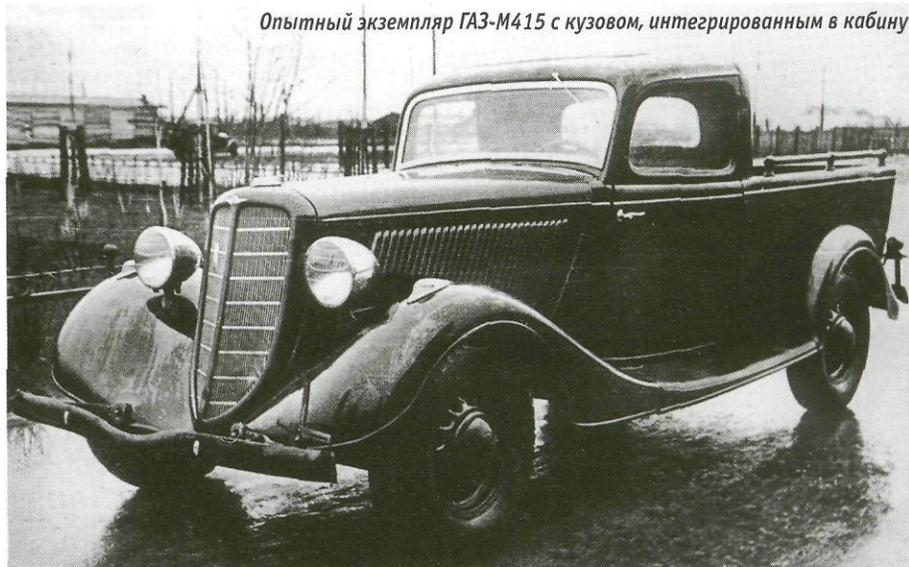
Опытный экземпляр ГАЗ-М415 с кузовом, интегрированным в кабину
