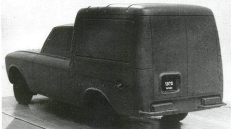
Масштабные макеты проработки дизайна будущего фургона ИЖ-2715
