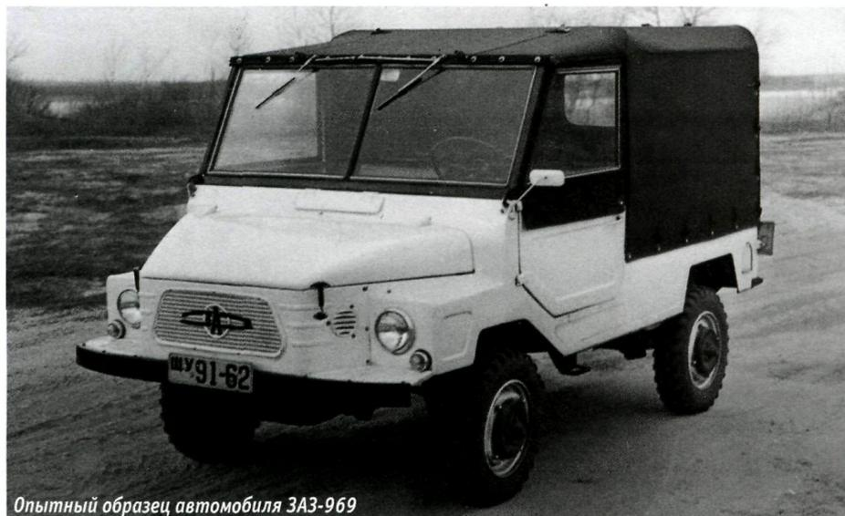
Опытный образец автомобиля ЗАЗ-969
