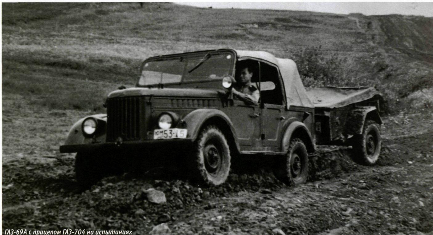
ГАЗ-69А с прицепом ГАЗ-704 на испытаниях
