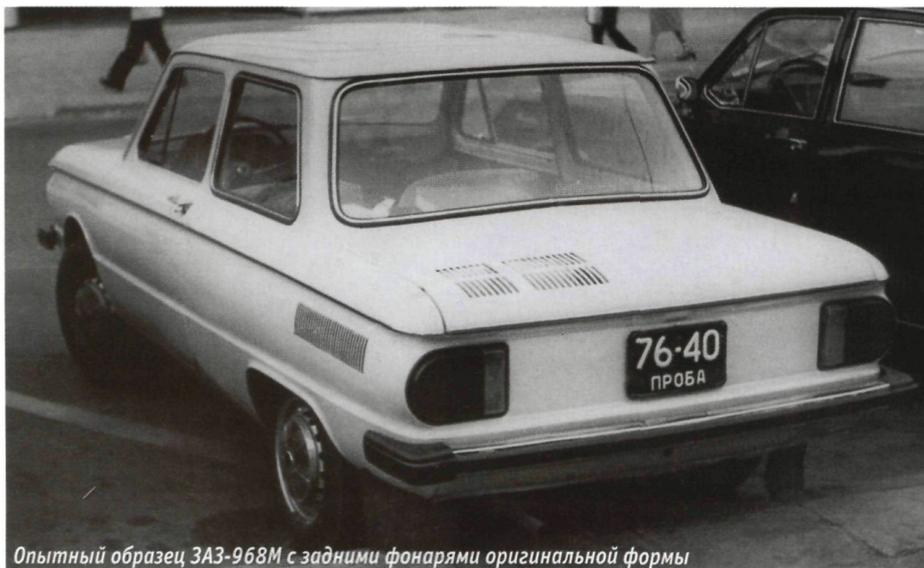
Опытный образец ЗАЗ-968М с задними фонарями оригинальной формы
