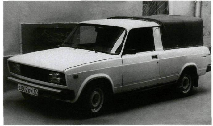
**ВАЗ-21045 и ВАЗ-21048.** В конце февраля 1998 года была изготовлена первая опытно-промышленная партия автомобилей ВАЗ-21045 (50 экземпляров) с дизельным вихрекамерным двигателем ВАЗ-341 объемом 1,57 л производства АО «Барнаултрансмаш». 31 января 2002 года первые два ВАЗ-21048 с отечественным дизельным двигателем 1,8 л были собраны и отправлены на ресурсные испытания. А 31 августа производство дизельных ВАЗ-21045 было передано группе компаний «СОК» для сборки на заводе «РосЛада» в Сызрани.
