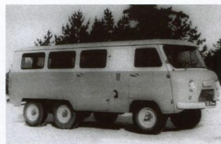
**УАЗ-452К** В 1973 году на Ульяновском автозаводе построили экспериментальный шестнадцатиместный трехосный автобус УАЗ-452К. Это была попытка улучшить проходимость и вместимость внедорожника за счет добавления еще одной оси, но, как показали испытания, неизбежное усложнение конструкции, повышенный расход топлива и возросшая масса свели на нет полученные преимущества. Поэтому серийного продолжения модель не получила.
