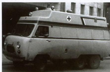
**«Медея»** На базе полноприводного УАЗ-452Д в конце 80-х годов в Грузии создали трехосные реанимационные автомобили «Медея» для нужд грузинских горноспасателей. Для производства этих машин использовали восстановленные шасси старых УАЗов с добавленной третьей осью и новым кузовом увеличенного размера. Реанимационные автомобили «Медея» в небольшом количестве производились кооперативом «Вездеход» из грузинского города Болниси в 1989–1994 годах.
